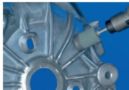
Le mole con gambo in **durezza F-ALU** sono costituite da un legante ceramico e carburo di silicio verde. La struttura molto aperta e la speciale impregnazione dell'utensile lo rendono ideale per la lavorazione di materiali ad alta viscosità. La durezza F-ALU è particolarmente adatta per l'alluminio e i metalli non ferrosi, e dimostra una notevole aggressività.
