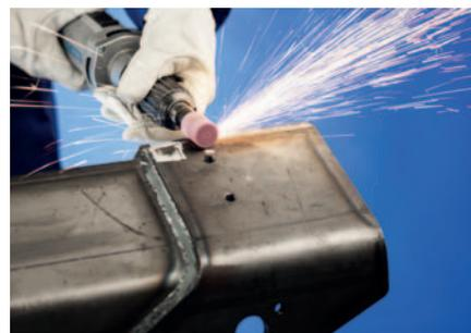
Le mole con gambo in **durezza M** sono costituite da un legante ceramico e una miscela abrasiva di corindone rosso scuro, tenace, e corindone bianco, più fragile. Questa combinazione di granuli abrasivi conferisce alle mole un rapporto equilibrato tra capacità di asportazione e durata dell'utensile. La durezza M è quella più utilizzata nell'ambito della lavorazione di acciai e fusioni di acciaio.
