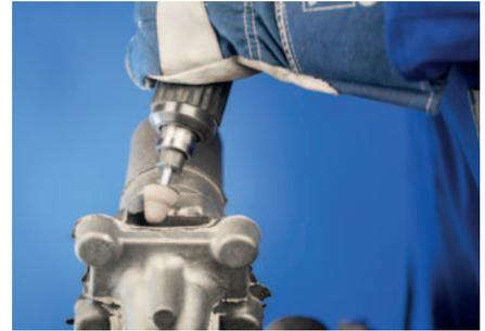
Le mole con gambo in **durezza N** sono costituite da un legante resinoide e corindone standard. Il legante relativamente duro contiene additivi che, in combinazione con i granuli tenaci di corindone standard, consentono alle mole di asportare grandi quantità di materiale. La durezza N è particolarmente indicata nella lavorazione di spigoli su acciaio INOX. Questi utensili tagliano freddo e mantengono inalterata la loro forma anche dopo l'uso.
