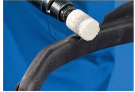
Le mole con gambo in **durezza D** sono costituite da uno speciale legante ceramico e corindone a sfera cava. La quantità limitata di legante e il tipo di abrasivo molto aggressivo caratterizzano queste mole, che sono le più tenere della gamma di mole con gambo PFERD. La durezza D è particolarmente adatta per materiali sintetici, gomma e legno.
