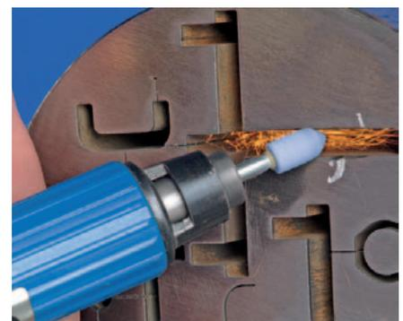
Grazie alle prolunghe è possibile allungare le mole con i diametri gambo 3, 6 e 8 mm, arrivando così a lavorare i punti difficili da raggiungere. Le prolunghe vengono montate nelle pinze della macchina (pneumatica o elettrica) o nell'impugnatura dell'albero flessibile. In alcuni casi le prolunghe sono una soluzione economicamente più conveniente rispetto alla produzione su richiesta di mole con gambo lungo.
