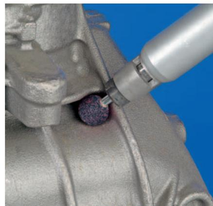
Le mole con gambo in **durezza K** sono costituite da un legante ceramico e una miscela di corindone rosa e corindone standard. Questa miscela di abrasivi, inglobata nel legante di media durezza, risulta resistente e dimostra un'elevata capacità di asportazione. Le mole in durezza K, utilizzate a velocità elevate, sono particolarmente indicate nella lavorazione di pezzi in ghisa.
