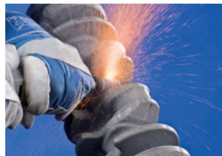
Le mole con gambo in **durezza R** sono costituite da un legante ceramico e carbonio di silicio grigio. L'abrasivo molto duro e l'elevato contenuto di legante conferiscono a queste mole una notevole durata. Le mole in durezza R, utilizzate a velocità elevate, sono particolarmente indicate nella lavorazione di pezzi in ghisa.
