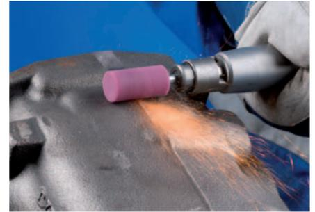
Le mole con gambo in **durezza O speciali per fonderie** sono costituite da un legante ceramico e una miscela composta da corindone rosa e corindone rosso. Questa combinazione di abrasivi conferisce alle mole buona capacità di asportazione e durata, specialmente nella lavorazione di pezzi in fusione di acciaio. La durezza O speciale per fonderie è particolarmente adatta a lavori di sgrossatura e asportazione grossolana di materiale.
