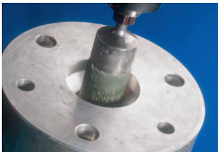
Adatte a spazzolature medio-pesanti. Permettono di lavorare con accurata precisione grazie ai fili racchiusi nel materiale sintetico. Ideali per l'uso in punti profondi e fori.
