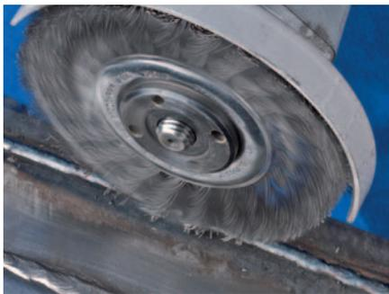
Spazzola aggressiva. Per la spazzolatura pesante delle costruzioni in metallo, per la rimozione di bruciature e ruggine, lo sbavo, la pulitura di cordoni di saldatura e l'eliminazione di residui di collante.
