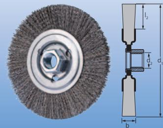
Adatte alla spazzolatura medio-pesante nella rimozione di bruciature e ruggine, sbavo e pulitura di cordoni di saldatura. Il filo non ritorto permette di creare superfici fini e lavorare in modo flessibile.
