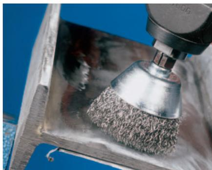
Adatte per tutte le operazioni di pulitura, rimozione di ruggine, levigatura, eliminazione di bruciature, corrosione e vernici. Da utilizzare frontalmente lavorando con tutto lo spessore dei fili. Adatte soprattutto su superfici grandi, piane e facili da raggiungere.
