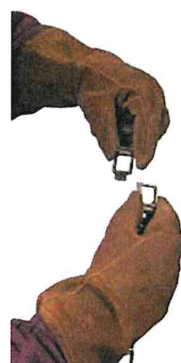
Le maglie della catena possono essere regolate facilmente per ottenere diversi diametri dei tubi.
