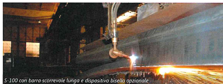
S-100 con barra scorrevole lunga e dispositivo bisello opzionale
