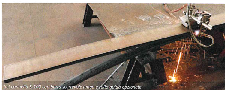
Set cannelli EPOCH con rotaia per impieghi gravosi
