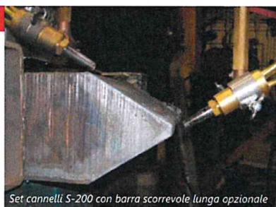
Set cannelli S-200 con barra scorrevole lunga opzionale
