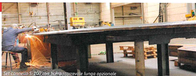
Set cannello S-100 con barra scorrevole lunga opzionale
