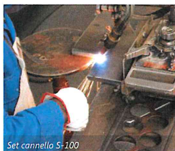
S-100 con barra scorrevole lunga e dispositivo bisello opzionale
