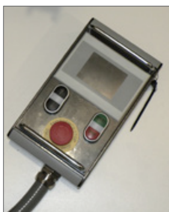
Selezione per lavoro in TIG plasma saldatura o Plasma taglio.
