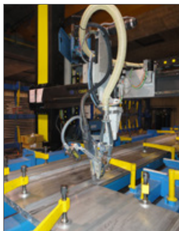
La testa di saldatura con telecamera TSV09 ed il seguigiunto IG 2D.
