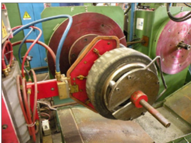
Giunto non saldato in fase di riscaldamento.
