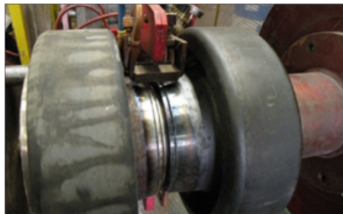
Giunto non saldato in fase di riscaldamento.
