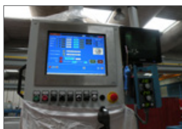
Il pulpito di comando con schermo touch da 10", monitor 7" per la telecamera, e pannello generatore MIG.
